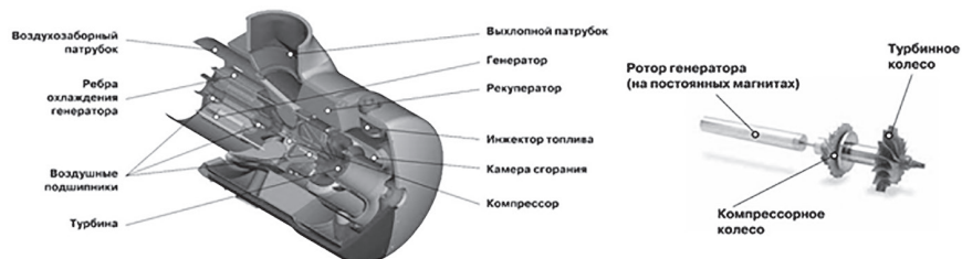
Рис. 4. Строение модуля высокооборотного микротурбогенератора Capstone
