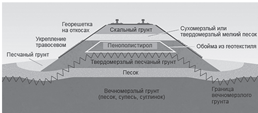
Рис. 1. Схематический поперечный профиль земляного полотна
