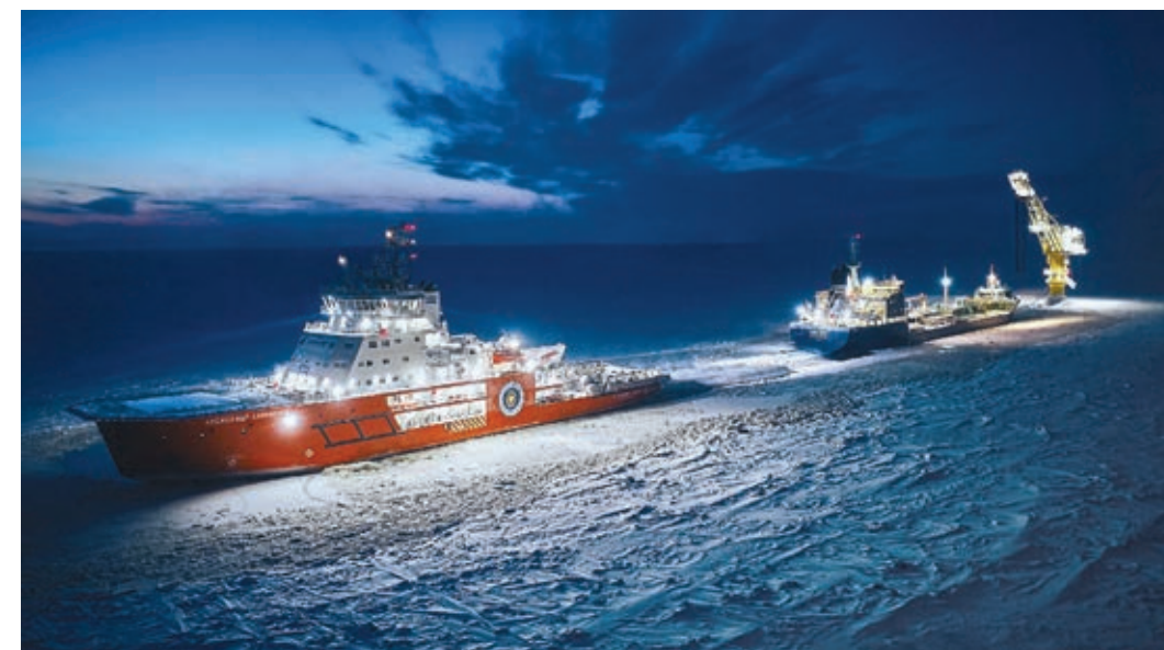
Рис. 17. Ледокол «Александр Санников» обеспечивает позиционирование танкера в процессе загрузки на терминале «Ворота Арктики»
