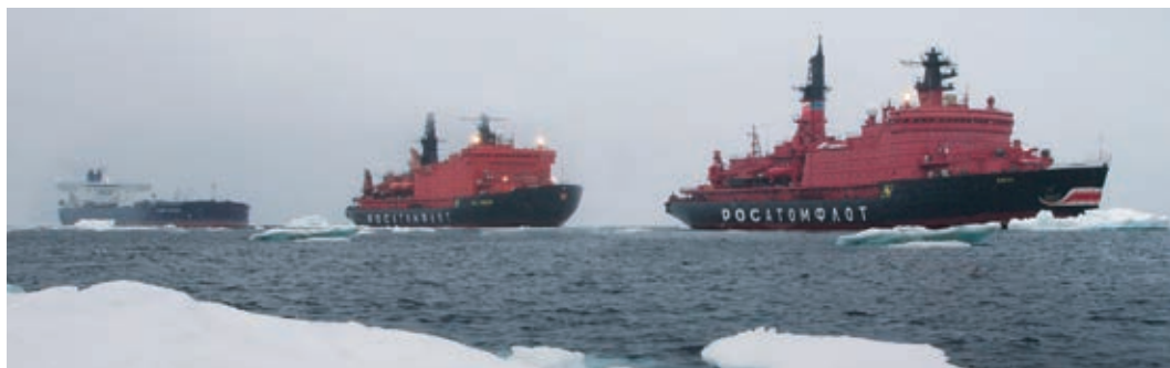
Рис. 24. Двухледокольный вариант проводки
