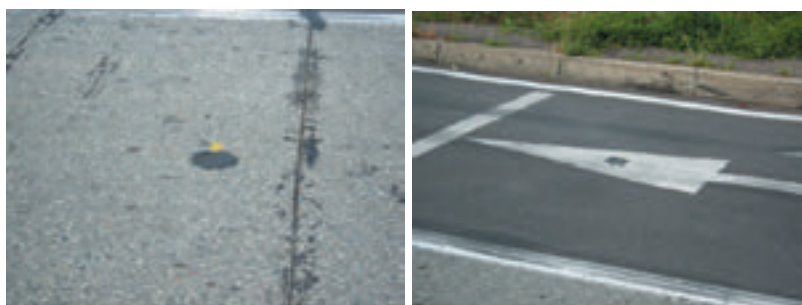
Рис. 48. Магнитометр в беспроводной сети датчиков (источник: ТСК г.Турина – Политехнический университет Турина)
