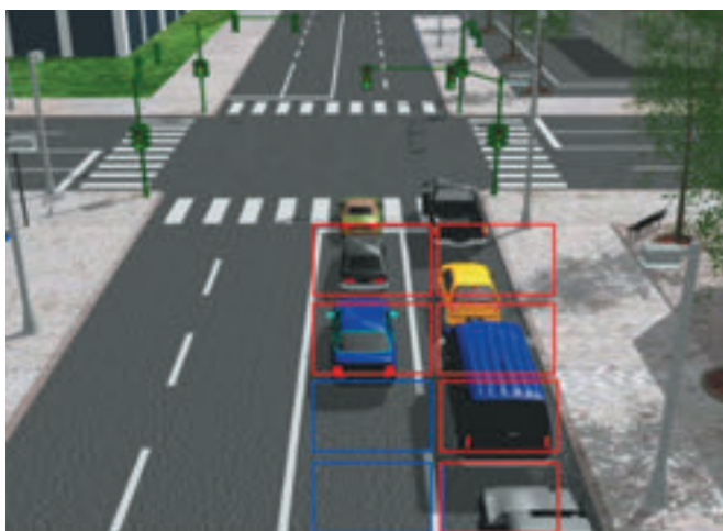
Рис. 39. Видеорегистрация с использованием виртуального индуктивного датчика
