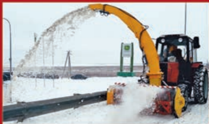
«БУРАН» Со складывающимся поворотным раструбом
