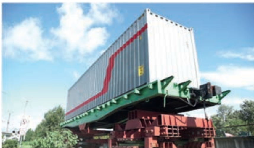
Рис. 2 – Образец магнитолевитационной грузовой платформы
