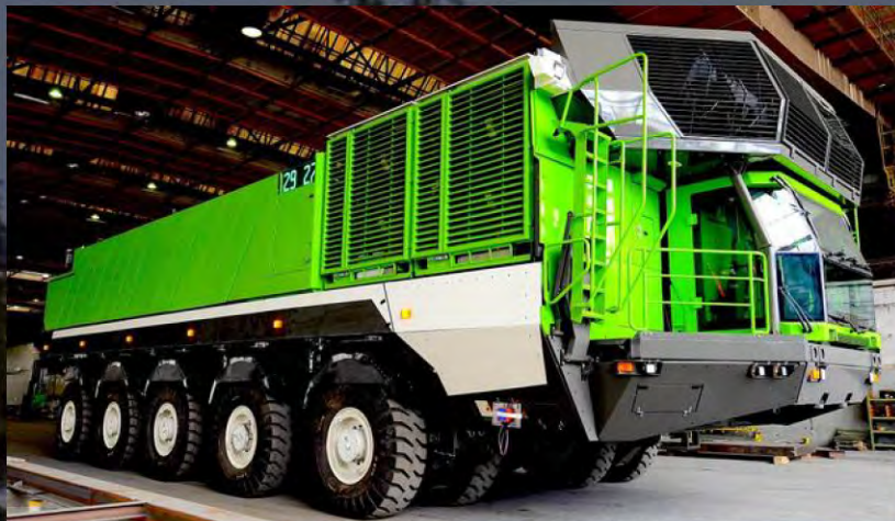
Модульные карьерные самосвалы грузоподъемностью 760 т. Компания ETF Mining Equipment, г. Марибор, Словения
